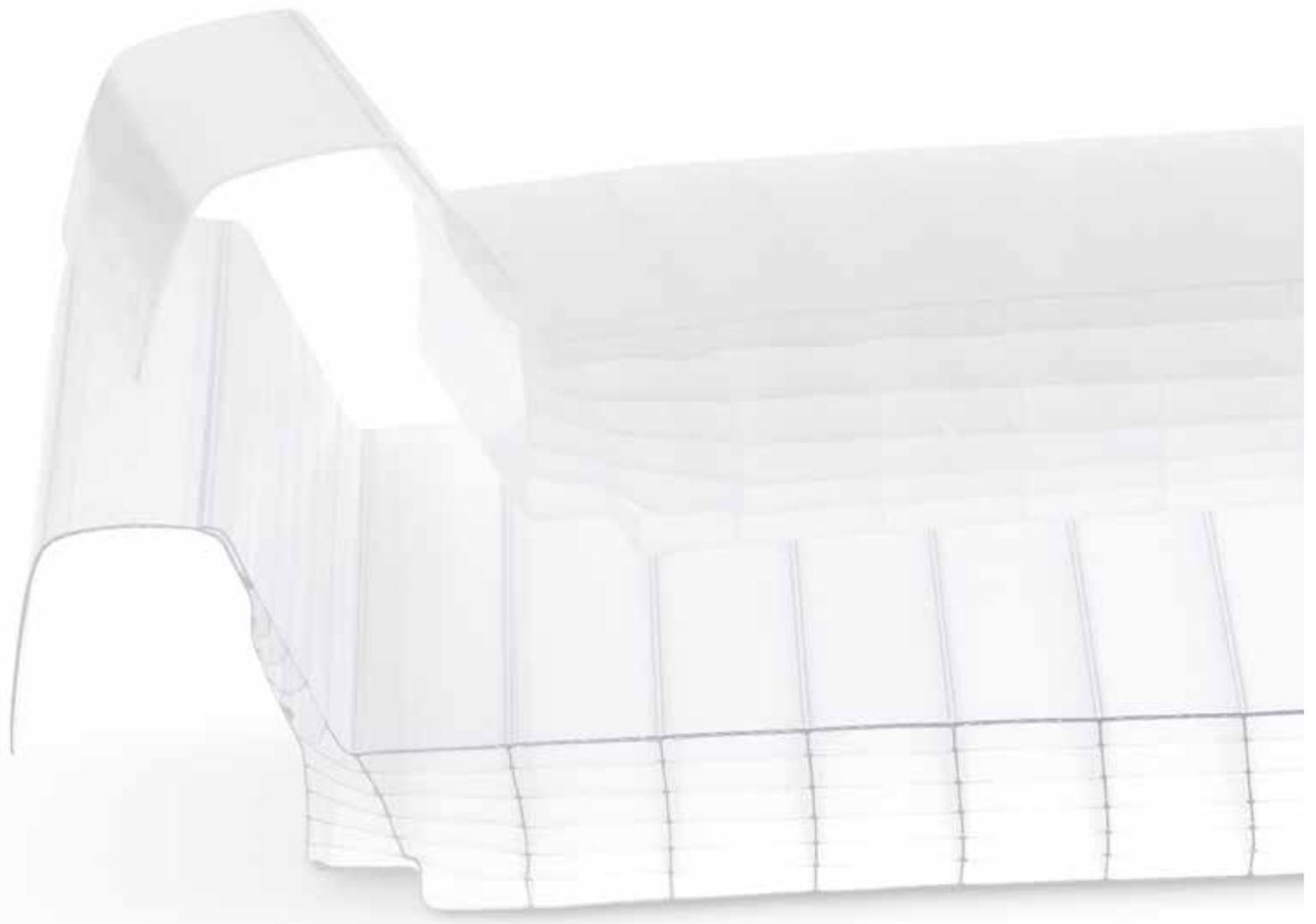
Sistema modulare piano con estremità grecate in policarbonato alveolare. Questa lastra grecata vanta una struttura a sette pareti alveolari con passo 1000 millimetri e spessore 30 e 40 millimetri.
